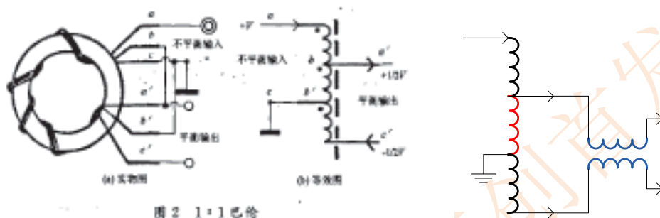
图 1 两输出端无需接平衡地的巴伦及实际实现电路
