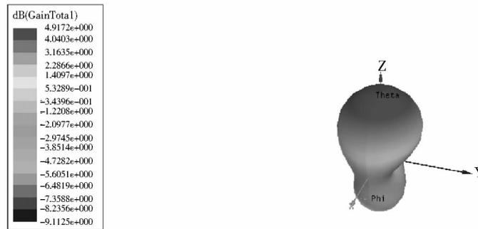
图 5 天线的三维增益方向图
