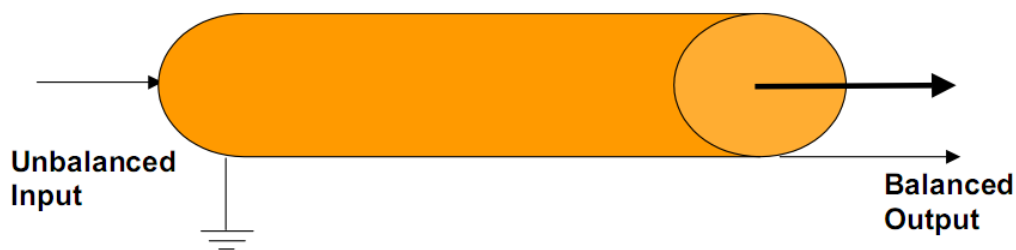
图 4 同轴巴伦，采用四分之一长度同轴电缆实现，1: 1 阻抗转换 如果要求阻抗转换为 1: 4，可使用图 5 中所述的同轴巴伦。
