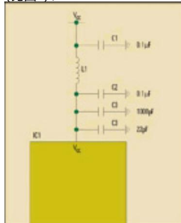
最小电容值通常取决于其自谐振频率和低引脚电感，C4的值就是据此选择的。C3和C2的值由于其自身引脚电感的关系而相对较大一些，从而RF去耦效果要差一些，不过它们较适合于滤除较低频率的噪音信号。电感L1使RF信号无法从电源线耦合到芯片中。记住：所有的走线都是一条潜在的既可接收也可发射RF信号的天线，另外将感应的射频信号与关键线路隔离开也很必要。
