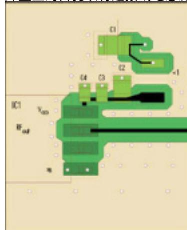
一块集成电路或放大器常常带有一个开漏极输出，因此需要一个上拉电感来提供一个高阻抗RF负载和一个低阻抗直流电源，同样的原则也适用于对这一电感端的电源进行去耦。有些芯片需要多个电源才能工作，因此你可能需要两到三套电容和电感来分别对它们进行去耦处理，如果该芯片周围没有足够空间的话，那么可能会遇到一些麻烦。
