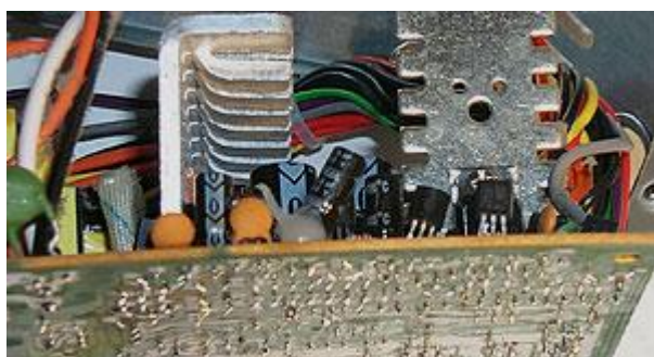
THT 零件（焊接在底部）
