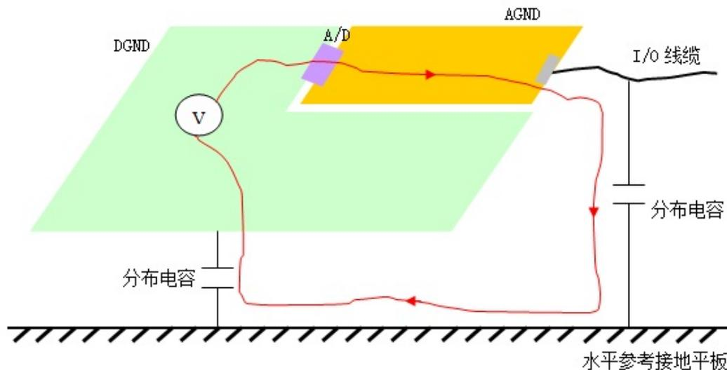
对于金属外壳的产品，因为单板需要接地，因此重点需要关注接地点，即接地点的设置要避免数字区域共模电流流经模拟区域。对于模拟区域无 I/O 线缆的情况，在进行数字与模拟分割后，可以在 A/D 芯片数字与模拟 GND 上设置接地点，避免数字区域的共模电流流经模拟区域。但对于模拟区域有 I/O 线缆的情况，因为线缆对地的分布参数，因此，存在共模电流流经模拟区域的风险，此时还需要充分考虑 I/O 线缆的长度，如音频耳机线因为比较短，可能分割后风险不大，但是，如果线缆很长的情况下，即使分割也有很大的风险。
