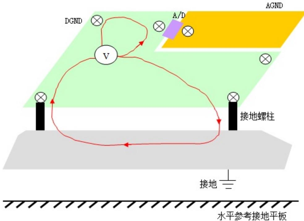
任何事物没有绝对正确性，数模分割同样如此，如果设计不好，会产生负面效果，比如跨分割布线等等，另外，高频时即使分割了，分割之间存在分布参数，因此，也不能形成完全意义上的分割。初学者或对 EMC 一知半解的工程师，如果对数模分割把握不准，建议尽量少分割或干脆不分割，保证 GND 平面完整，降低 GND 平面的阻抗，同样可以减少数字对模拟干扰的风险。
