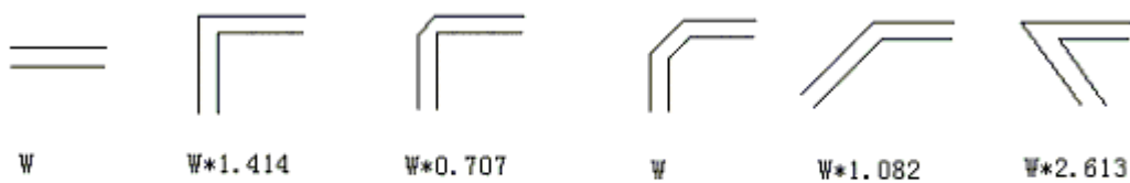
图1-8-13 不同角度走线的拐角线宽变化
