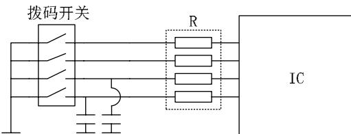
采用电容或TVS管 + 限流电阻的方式进行静电干扰抑制。电容的典型值为560pF。
