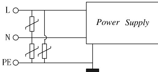
使用压敏电阻进行电源输入侧的共模和差模防护设计。
