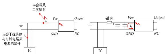
时钟器件的电源去耦方式一般为：磁珠 + 10uF电容 + 高频电容；
