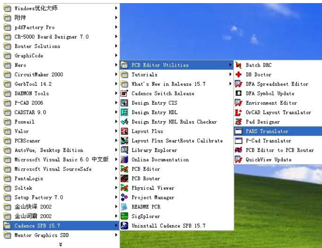
图 2 选择 cadence 的 PADS 转换程序
