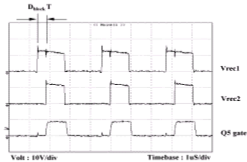
图 8.二次侧第一、第二路输出整流前电压波形
