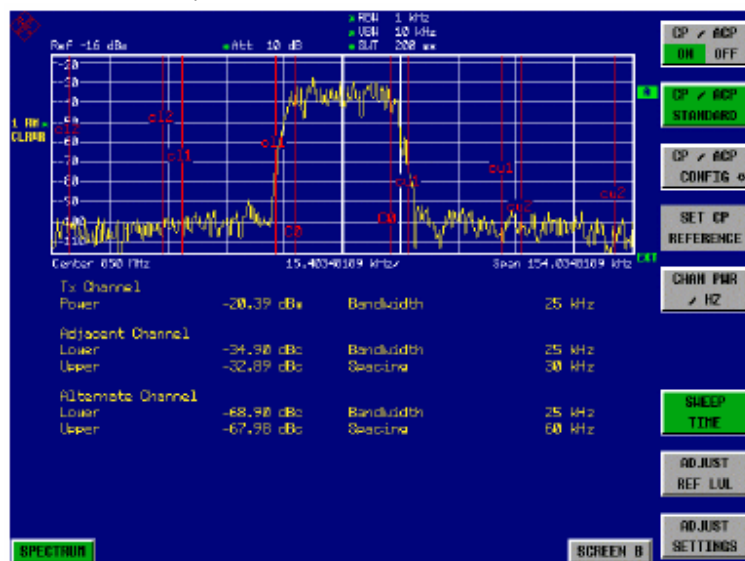
图2-39 在传输信道上下各两个邻道中测量NADC的相对邻道功率
