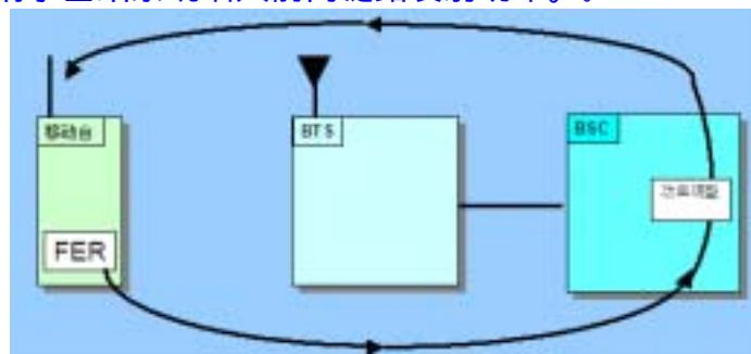
但功率控制的能力和性能很大程度上依赖于功率测量的精度和功率控制命令产生和传输处理时延。另一方面，由于信号在移动通信传输中呈瑞利衰落，功率控制系统无法补偿由快衰落引起的信号功率的变化，特别是当移动台的运动速度很快时，功率控制技术会失效。尽管如此，功率控制技术仍然是一个成功的CDMA移动通信系统必不可少的一项关键技术。
