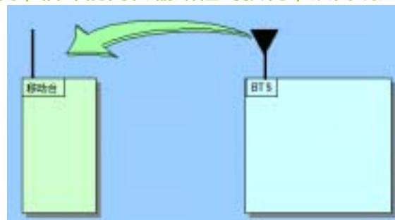
**反向闭环功率控制**：闭环功率控制的设计目标是使基站对移动台的开环功率估计迅速做出纠正，以使移动台保持最理想的发射功率。基站检测信噪比 SNR，与门限值比较，产生对移动台的功率控制命令；每 1.25 ms 更新一次（每秒重复 800 次）；校正开环功率控制未消除的、与前向链路相独立的损耗。闭环功率控制是在移动台的协助下完成的。基站接收移动台的信号，并测量其信噪比，然后将其与一门限作为比较，若收到的信噪比大于门限值，基站就在前向传输信道上传输一个减小发射功率的命令；反之，就送出一个增加发射功率的命令。闭环功率控制可以修正反向传输和前向传输路径增益的变化，消除开环功率控制的不准确性。
