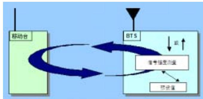
**前向功率控制**：在前向功率控制中，基站根据测量结果调整对每个移动台的发射功率，其目的是对路径衰落小的移动台分派较小的前向链路功率，而对那些远离基站的和误码率高的移动台分派较大的前向链路功率。前向功率控制的目的主要是通过在各个前向业务信道上合理的分配功率来确保各个用户的通信质量，同时使前向链路容量达到最大。前向功率控制是在移动台的协助下完成的。移动台检测前向传输的误帧率，并向基站报告该误帧率的统计结果。基站根据移动台报告的误帧率统计结果，决定增大还是减小前向传输功率。基站系统缓慢地减少对每一移动台的前向链路发射功率；当移动台检测到FER增大，就请求基站系统增大前向链路发射功率。。
