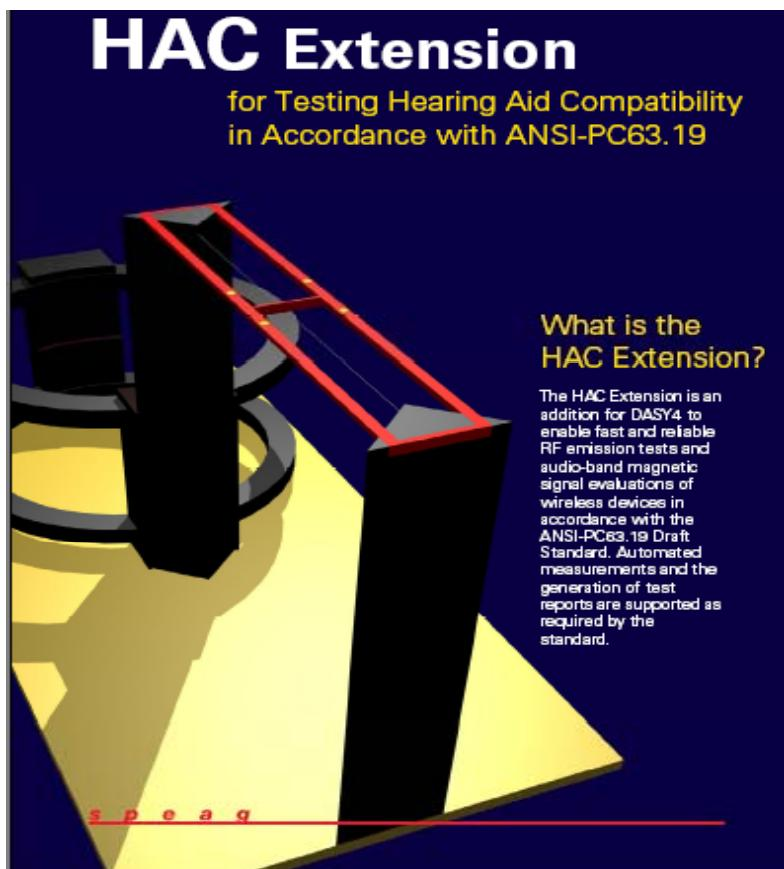
**HAC 與 T-Coil 用來測試 Wireless Devices 和 hearing aids, RF 測試和聲音頻帶電磁訊號評估的無線設備,根據 ANSI -PC63.19 草稿標準。使自動化量測和試驗報告依標準要求。**
