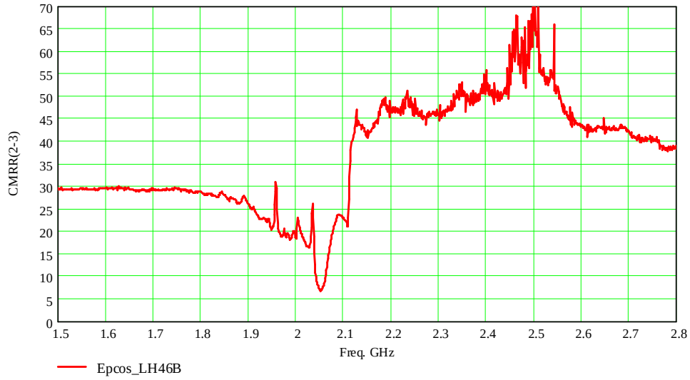
图 5：共模抑制比（端口 2，3 至共模端口）
