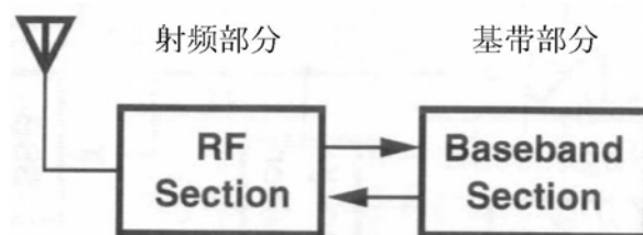
图 1.3 接收发送器的射频和基带处理
