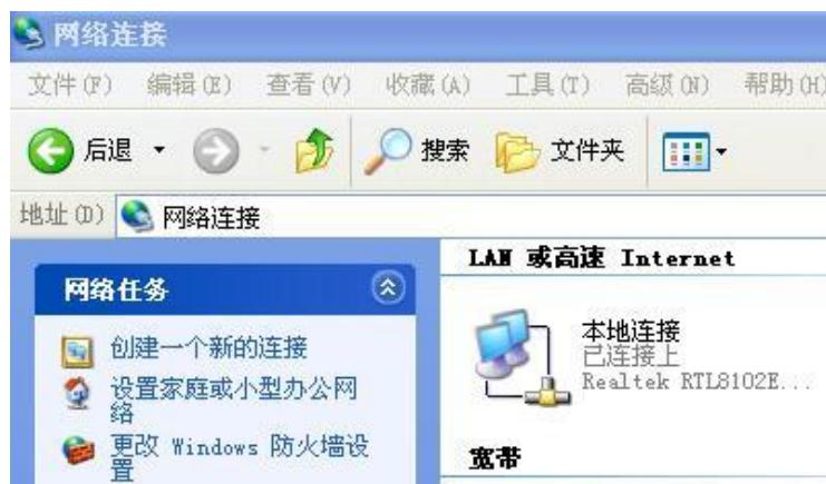
2. 双击“本地连接”，在弹出的对话框里，选中“Internet 协议 (TCP/IP)”，然后点击“属性 (R)”，如图：
