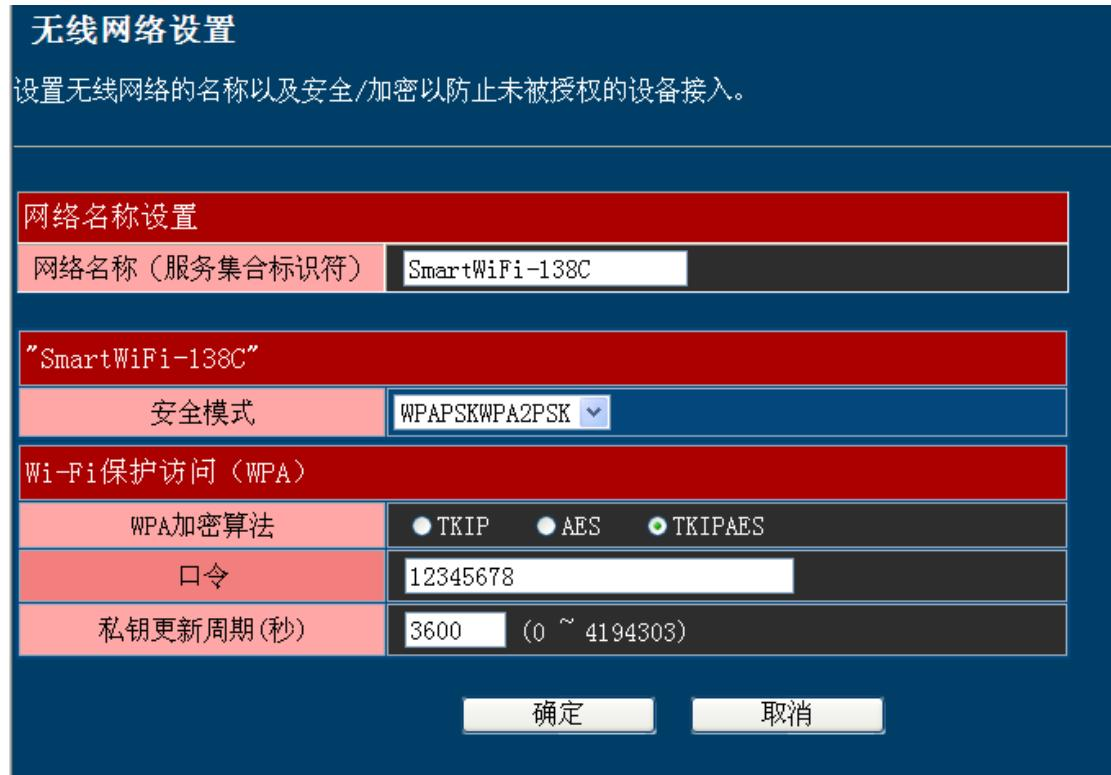
路由器的基本设置完成后，您可以点击首页的“高级设置”图标，在里面可以查看路由器与 ISP 局端的连接状况，如果您的路由器“Internet 配置”显示已成功获的相应的 IP 地址，DNS 服务器等信息，那么恭喜您，现在可以上网冲浪了。
