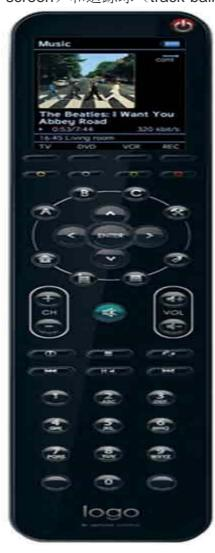
M-Remote 可使终端用户方便、直观地访问和欣赏数字内容和服务。例如,浏览图书馆中的数字音乐,互联网电台清单,或者在遥控器的显示屏上显示连续播放状态和图像。此外,RF 技术还克服了 IR 技术的视线障碍,允许穿过物体甚至障碍物(一般障碍墙为 15 米,假设墙体材料不过分吸收 RF 信号)。
