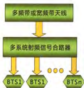
图2 多系统通过合路器共用宽频带天线
