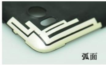
绝大部分的过孔、斜坡、弧面通过3D印刷直接可以实现导通
