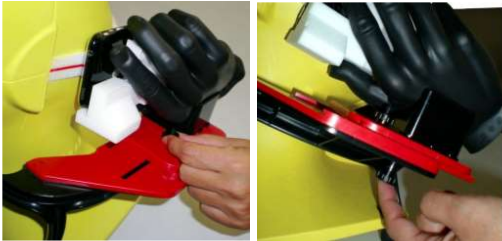
图12 PDA类EUT人手位置固定方法
