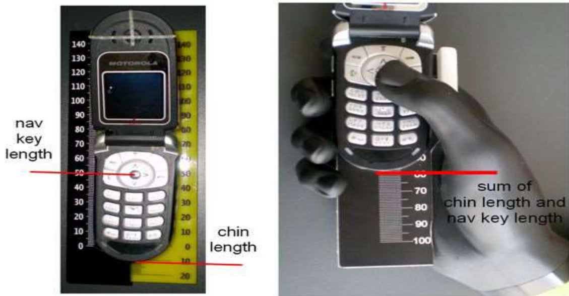
图 16 Fold/Open Slide 类 EUT 与 Narrow Data 手模位置固定方法
