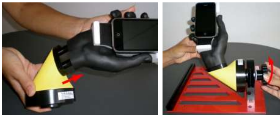
图 14 EUT/Hand 与 Data Mode Fixture 夹具组装方法
