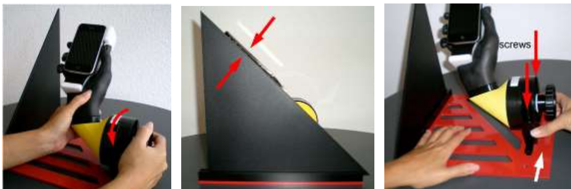
图 15 EUT/Hand 与 Data Mode Fixture 夹具定位方法
