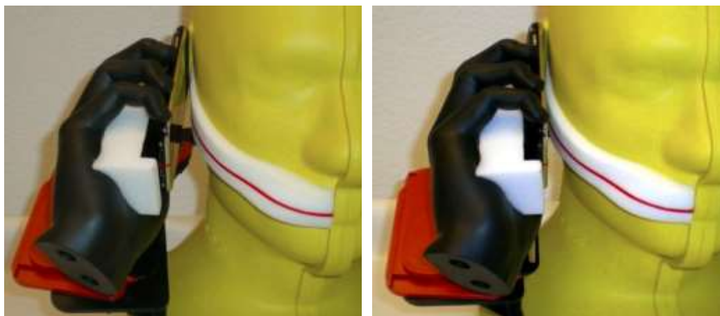
图13 PDA类EUT人头加人手位置固定方法
