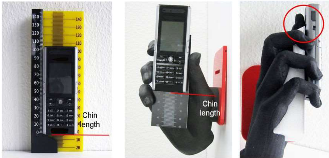
图5 直板EUT与手模位置固定方法
