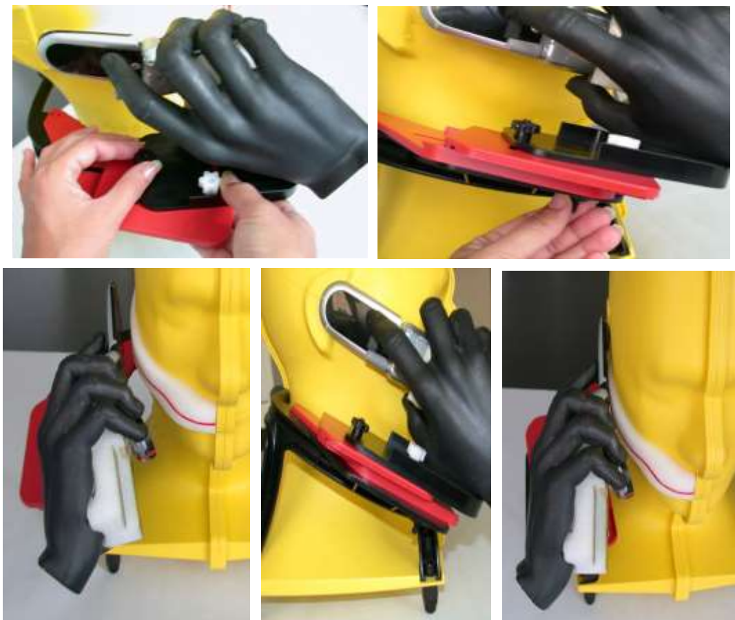
图11 Fold/Open Slide类EUT人头加人手位置固定方法
