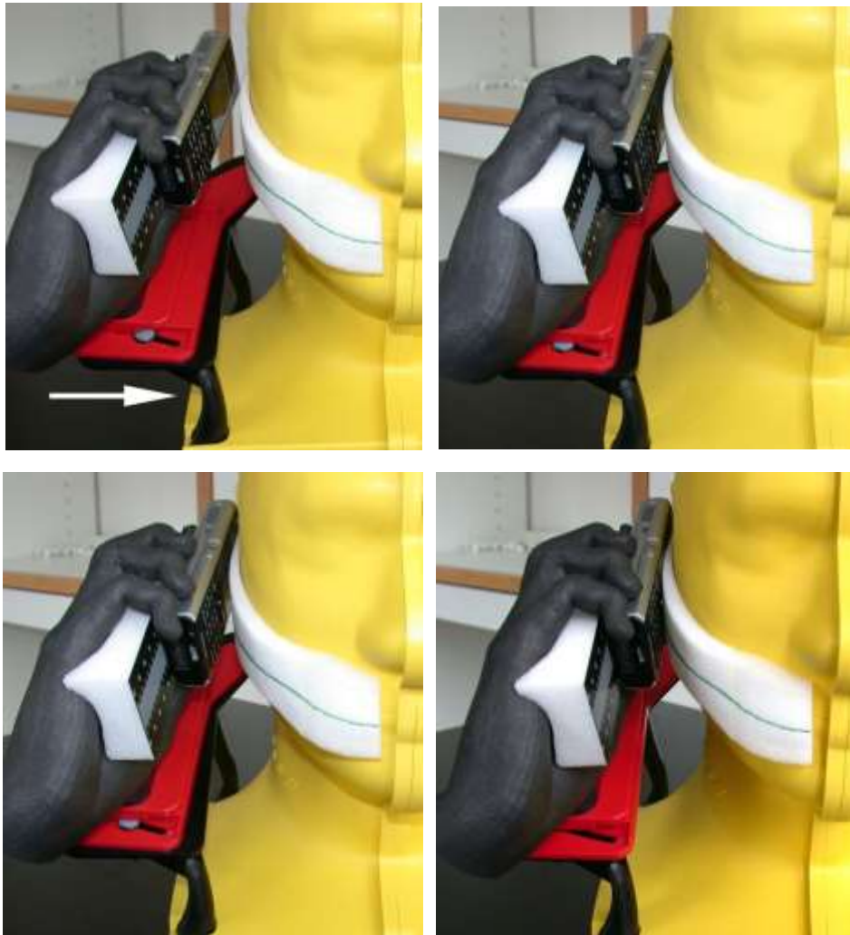
图9 Monoblock /Closed Slide类EUT人头加人手位置固定方法
