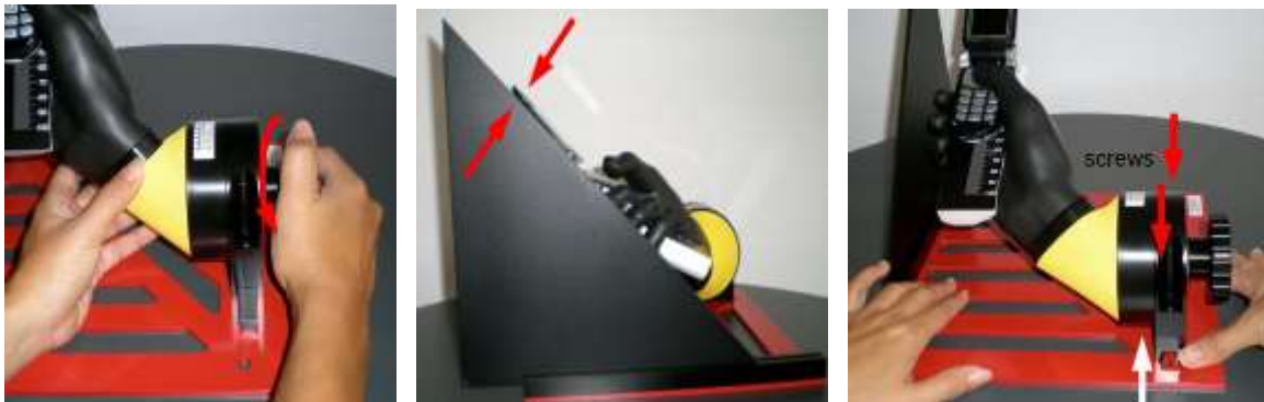
图 18 EUT/Hand 与 Data Mode Fixture 夹具定位方法
