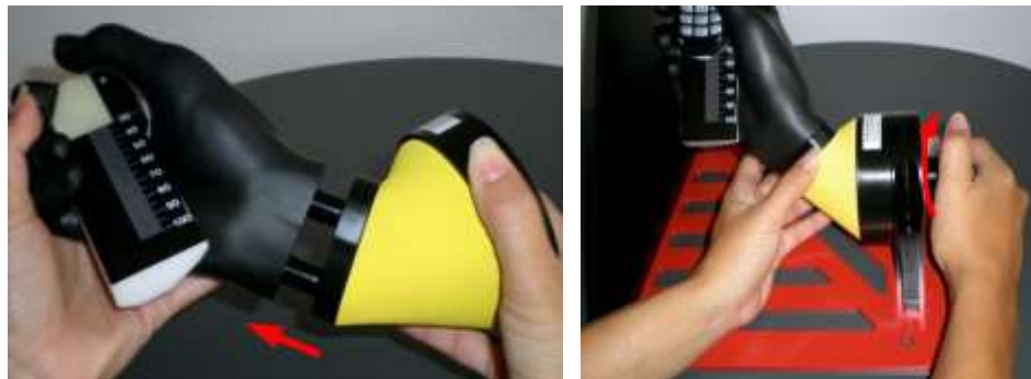
图 17 EUT/Hand 与 Data Mode Fixture 夹具组装方法
