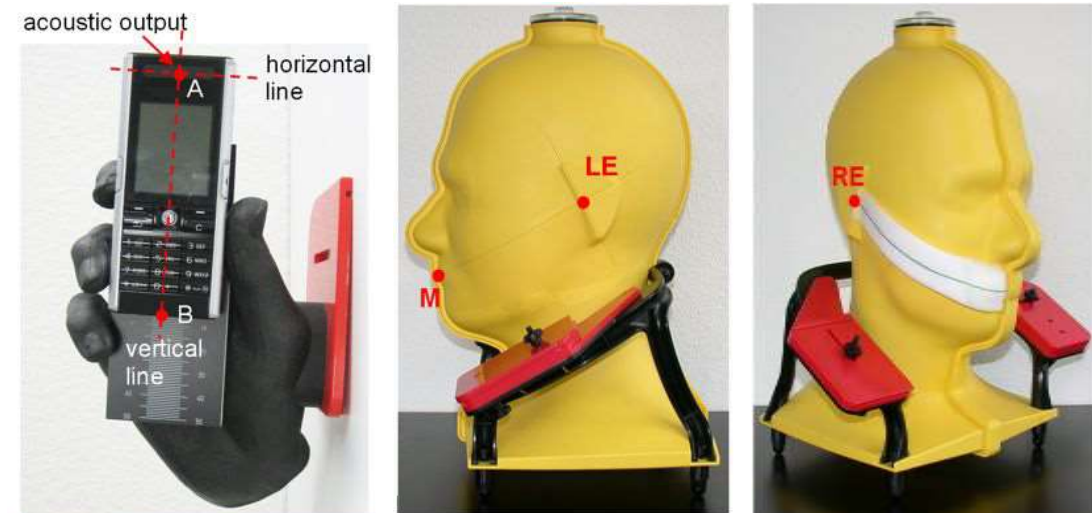
图8 Monoblock EUT中心标识及 6^{\circ} 夹具固定
